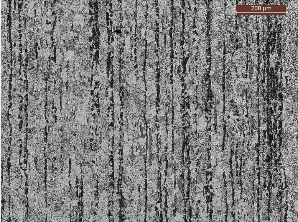
*Figure 160 - 11SMnPb30 longitudinal 100X*
