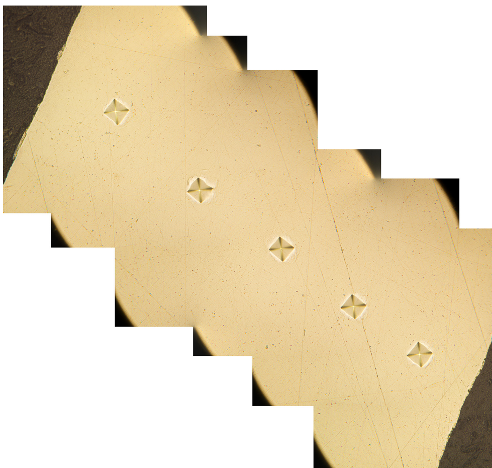
Figura 7.35: Micrografia di una serie di cinque impronte vickers effettuate perpendicolarmente allo spessore sulla sezione di un provino in AISI 304.
