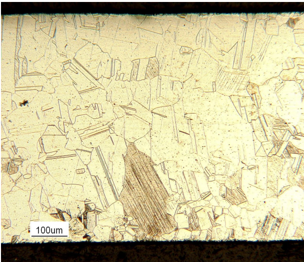
Fig. 5.27 – Micrografia trasversale del campione a 1050°C per 1 ora. a) 100x e b) 200x.
