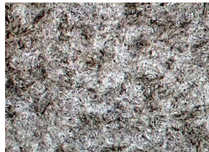
struttura x500 assenza di ferrite e carburi non sciolti
