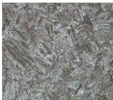
Laminato Temprato e Rinvenuto martensite con tracce di bainite X500
