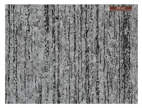
Figure 160 - 11SMnPb30 longitudinal 100X
