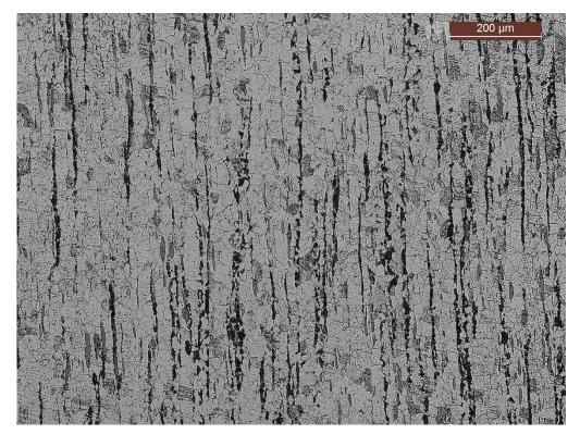
Figure 161 - 11SMnPb37 longitudinal 100X
